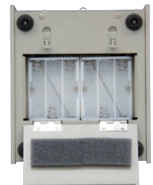
乾電池は底面にセットします
